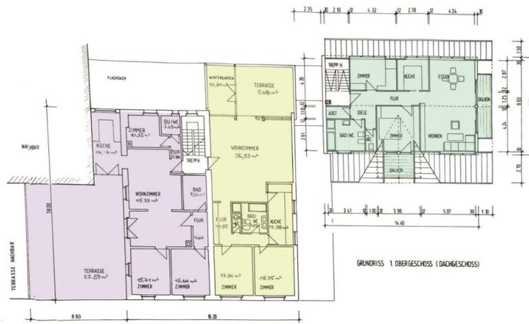
GRUNDRISS 1. OBERGESCHOSS (DACHGESCHOSS)
